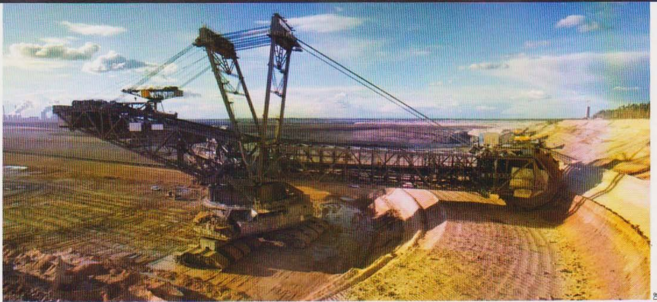
▲ Excavatrice à godets dans une mine à ciel ouvert
