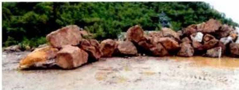
Toutes les mesures seront prises pour que leurs dimensions et leurs litages soient le plus proche possible de l'existant, dans la mesure des possibilités techniques, les enrochements devant assurer une consolidation pérenne (enrochements de taille homogène et de calibre 1m<sup>3</sup> projetés).
